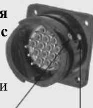
стальной штырь контроля износа контрольная желтая метка
