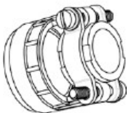
Кожух с кабельным зажимом Прямой – CS Угловой 90° – CE
