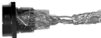
Ф – экранирующая оплетка должна обволакивать корпус соединителя
