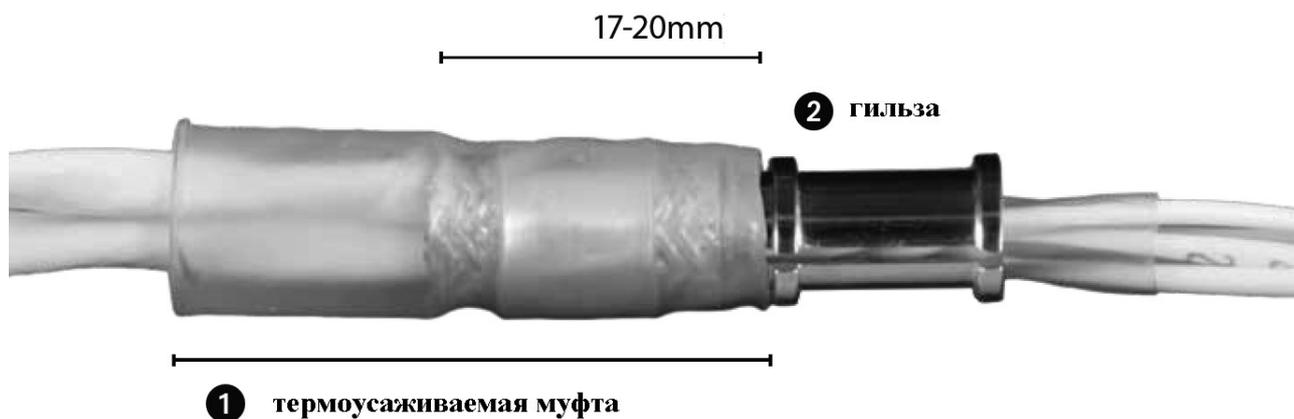
Убедитесь, что термопистолет закреплен, температурный режим выставлен на рекомендуемое значение (дайте пистолету прогреться в течение 1 минуты). Муфту и гильзу кабеля разместите в центре потока горячего воздуха, стараясь не прикасаться к отражателю
