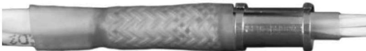
Дождитесь полного остывания сборки, прежде чем прикасаться голыми руками. Проверьте на наличие порезов, трещин или обугленных пятен на муфте. Резкий, четкий цвет указывает на перегрев муфты. Небольшое потемнение муфты является приемлемым. Убедитесь, что армированный слой не торчит из-под муфты. При наличии таких явных повреждений, удалите поврежденную муфту и замените ее новой (687-808-02 или 687-808-04)
